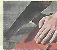
Dachs auf jede Seite eine Kerbe gesägt. Dafür das Dach an den Rahmen legen und die Auflagestelle markieren. In diese Stelle eine durchgehende Kerbe von 3 mm Tiefe sägen. Die Holzkeile werden in den inne-
